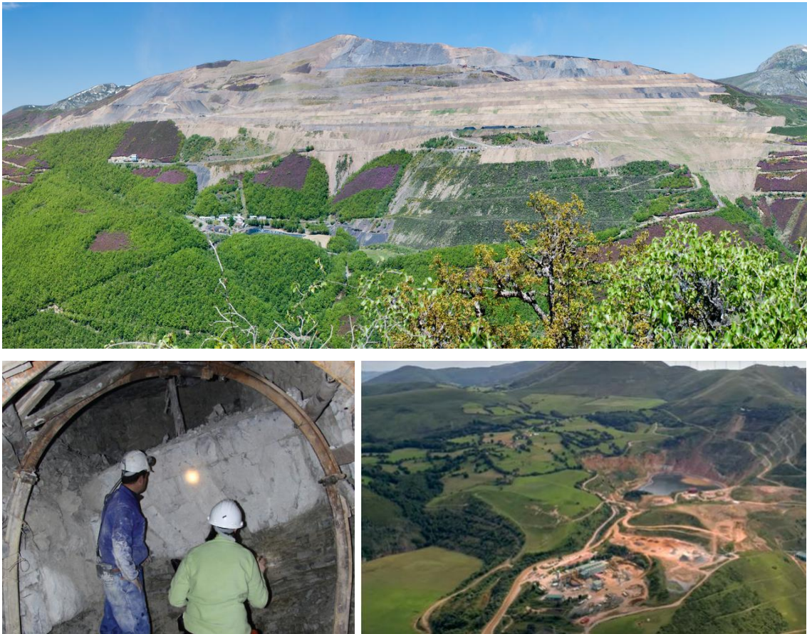
Figura 3. Tipos de explotación minera. Explotación a cielo abierto para la obtención de antracita en la zona de Cerredo. Mina de interior para el beneficio de caolín. Minería mixta para la extracción de oro en Belmonte de Miranda.
