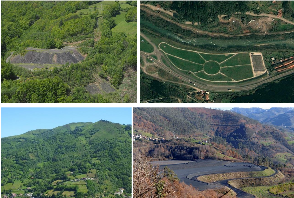
Figura 6. Tipos de restauraciones de escombreras. De izquierda a derecha y de arriba abajo: Escombrera expuesta sin restaurar en la zona de Gillón. Escombrera antropizada por la construcción de un área recreativa en la zona de Bustiello. Antigua escombrera revegetada de manera natural en la zona de Moreda. Escombrera en proceso de restauración artificial, mediante la construcción de taludes y bermas en la zona de Mieres.
